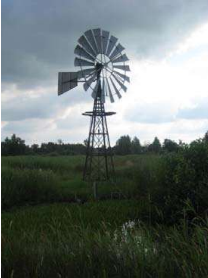
Een windmotor onder Nijetrijne in bedrijf; de windvaan staat loodrecht op het windrad.
